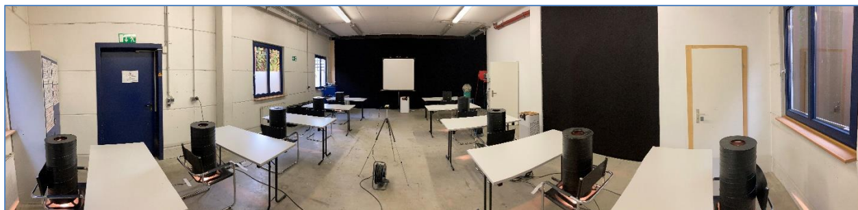
Figure 4.1: PURIFIAIR.620 d'asecos dans la salle de classe afin de déterminer la réduction des concentrations de l'aérosol d'essai DEHS conformément à la VDI EE 4300 Blatt 14
