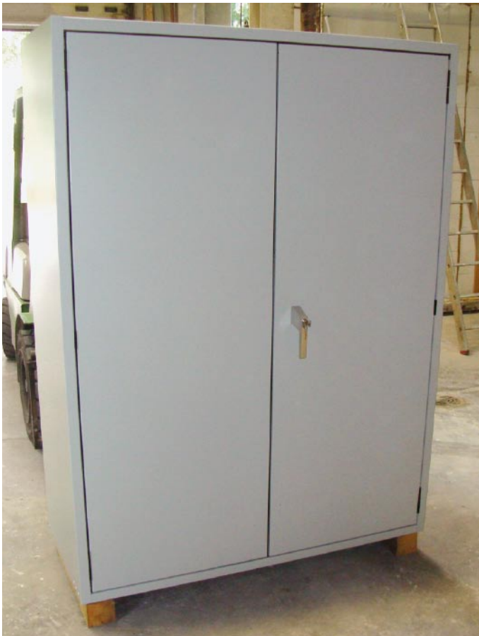
Abb. 2: Außenansicht des zur Brandprüfung vorbereiteten zweiflügeligen Sicherheitschrank von asecos.
