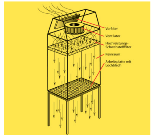
Wirkungsweise Laminar Flow Box FBS Serie
