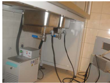
Raccordement des bacs de rétention aux ultrasons à l'alimentation électrique
