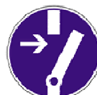
vor Arbeiten freischalten
